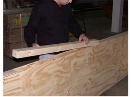
**Lagerhölzer wieder an der Transportposition einsetzen**
