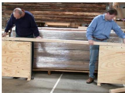
Zum Schluss wird der zweite Torbalken zwischen B13 und B14 eingesetzt.
