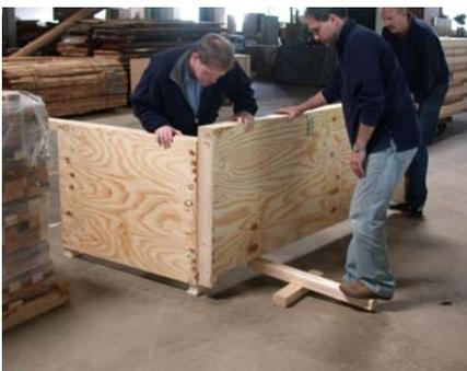
Begonnen wird mit den Elementen B14 und B1, wobei B1 von oben in B14 eingehakt wird. Dazu kann man die Hebelhölzer zur Hilfe nehmen.
